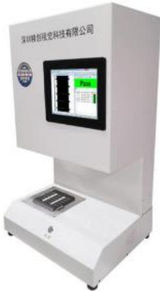
Это автоматизированное устройство оптического контроля может определять длину и ширину магнитных полос, отображать результаты измерений в режиме реального времени и автоматически определять, соответствует ли оно требованиям (ОК) или несоответствию (НГ). Когда образец будет признан некачественным (NG), это будет сопровождаться голосовой подсказкой.
