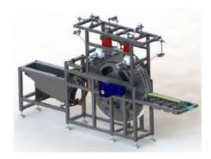
Это оборудование для проверки внешнего вида представляет собой комплект оборудования автоматической сборочной линии, предназначенный для палочек для мороженого.
