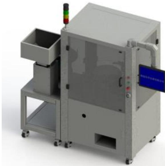
Устройство представляет собой полностью автоматизированное устройство для косметического контроля кнопок, которое в основном используется для обнаружения дефектов (сломанные края, сломанные отверстия, три отверстия, смешанные материалы, отверстие для штифта, пузырьки, волочение проволоки и т. д.).
